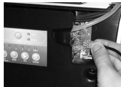
Raccorder le bouton poussoir au connecteur 'BP' (pas de polarité). Section : 0,25 à 1,5 mm 2
