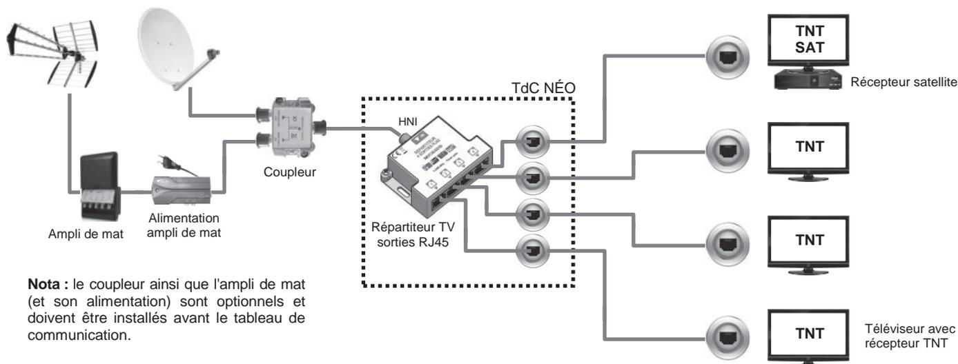
**Nota :** le coupleur ainsi que l'ampli de mat (et son alimentation) sont optionnels et doivent être installés avant le tableau de communication.
