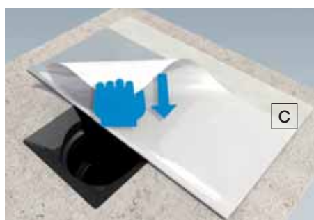
Dépoussiérer autour de l'avaloir. Positionner la natte d'étanchéité (C). La plier en 2. Ôter le film protecteur.
