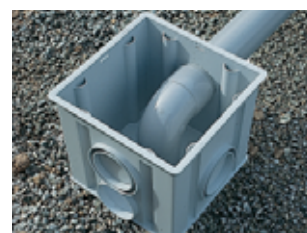
Pour créer un siphon, mettre en place un coude plongeur CT8 ou CX8 éventuellement recoupé.
