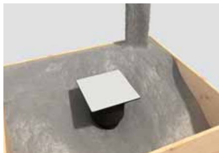
Couler la dalle en béton ou reboucher avec un mortier de scellement. Le protecteur polystyrène est affleurant à la surface coulée.
