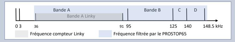
Bande CENELEC A: Réservé pour les fournisseurs d'électricité. => Compteur Linky (36 Khz à 91 Khz)
