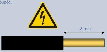
3/ Utilisez des fils rigides ou des embouts dans le cas de fils toronnés
