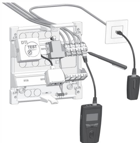
1 - Vérifier la conformité du système de protection (continuité électrique de la mise à la terre) entre la terre générale, le bornier de terre du coffret, et l'ensemble des éléments (masses métalliques, blindages...) y étant raccordés le cas échéant.
