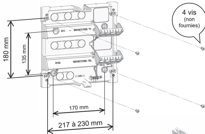
En cas d'utilisation de pattes de liaison (livrées avec Extension et Zone Atténante), ouvrir les prédécoupes du socle avant de le fixer.
