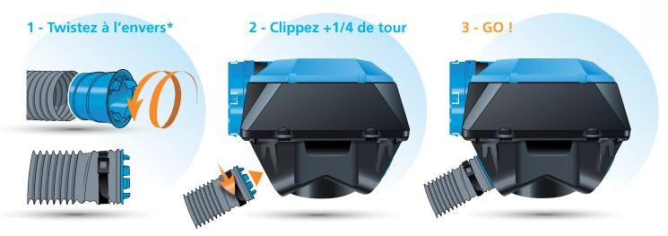
Il vous suffit de visser le piquage dans la gaine dans le sens inverse des aiguilles d'une montre. Fixez ensuite le collier de serrage. Il est recommandé d'utiliser des conduits calorifugés.
